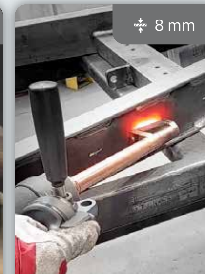
HEAT SHRINKING - CHAUDE DE RETRAIT Large L90 Powerduction 160 LG
