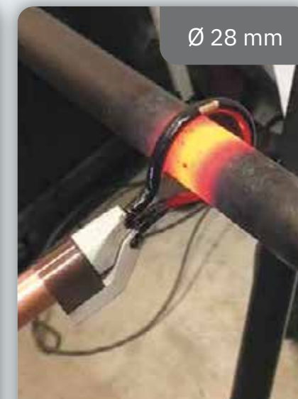
STEEL ANNEALING - DÉTREMPE ACIER Small S180/D35 Powerduction 160 LG
