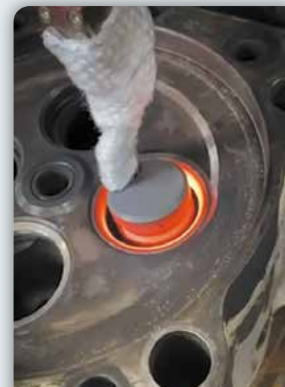
VALVE SEAT REMOVAL - EXTRACTION SIÈGES DE SOUPAPE Heat Tube D37 Powerduction 220 LG
