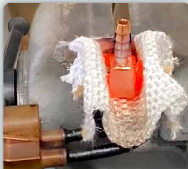
BRAZING BRASS PARTS - BRASAGE PIÈCE LAITON Large L90 BRAZ 28 Powerduction 160 LG
